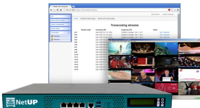
Программный транскодер для головных станций Streamer 8x, Combine 8x и Transcoder server. Позволяет транскодировать видеопотоки из MPEG-2 в h.264 и обратно в реальном времени. Поддерживает scaling и transrating.
